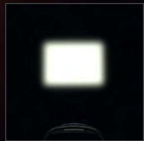
フロストフィルターを使うことでソフトで均等なエッジ表現が可能。
